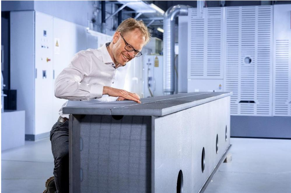
**Dr. Dirk Dittrich vom Fraunhofer IWS hat mit einem Team aus Forschung und Industrie ein leistungsfähiges Laserschweißverfahren entwickelt. Anhand eines lasergeschweißten Hallenkranssegments zeigte das Team, dass das Verfahren im Stahlbau in erheblichem Maß Ressourcen einsparen kann.**
